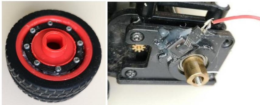
Figure 22 - Bague en PLA noir avec les vis métalliques (à gauche) et capteur KMI16 (à droite)
