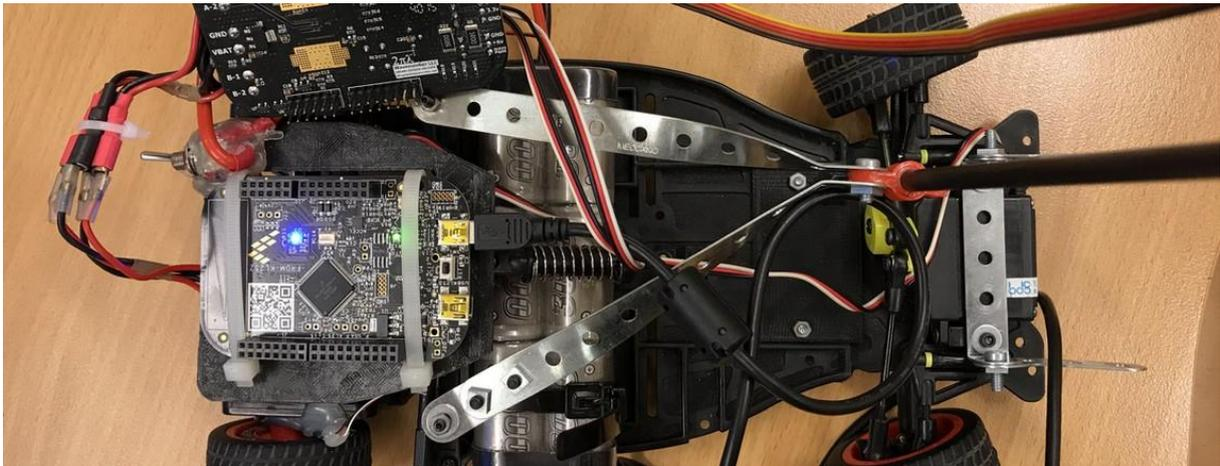
Figure 6 - Carte KL25Z sur châssis « modèle C »
