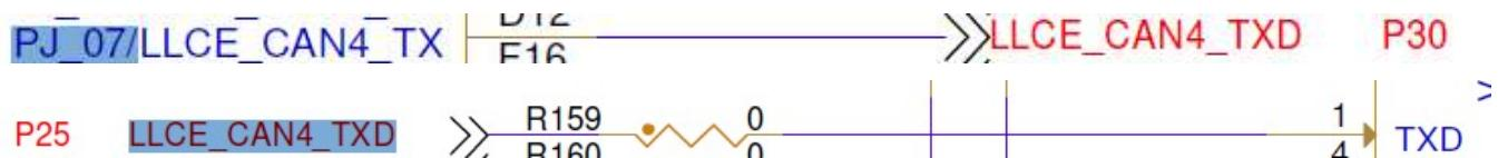
所以将 R159 对地轻触，则会触发 GPIO151 的下降沿中断，从而调用到 ICU 注册的 Callback 函数中，导致 UserCountIrqCH0 开始向上计数，则调用 DIO 驱动翻转 GPIO6 的 LED 灯闪烁。
