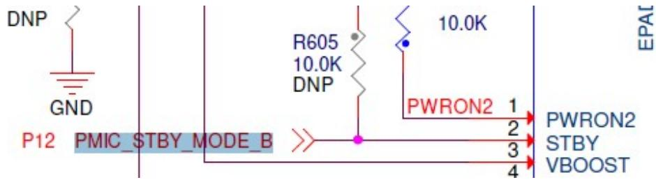
S32G 通过拉动 PMIC\_STBY\_MODE\_B 管脚来通知 PMIC 进入或退出 Standby，所以可以通过量测 TP109 的电平变化来看 S32G 是否进入了 Standby 状态，此管脚电平切换是一个硬件行为。
