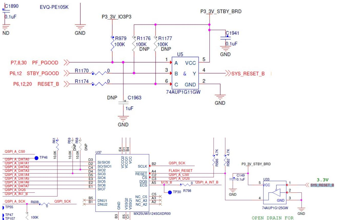
所以在 STBY 退出后，PMIC 上电，然后拉动 STBY\_PGOOD 通知外设退出 STBY，此时会 reset 外部 QSPI NOR，这样保证 STBY 退出时，M 核做 full boot 的时候，QSPI NOR 会 reset 到初始化状态，保证启动成功。
