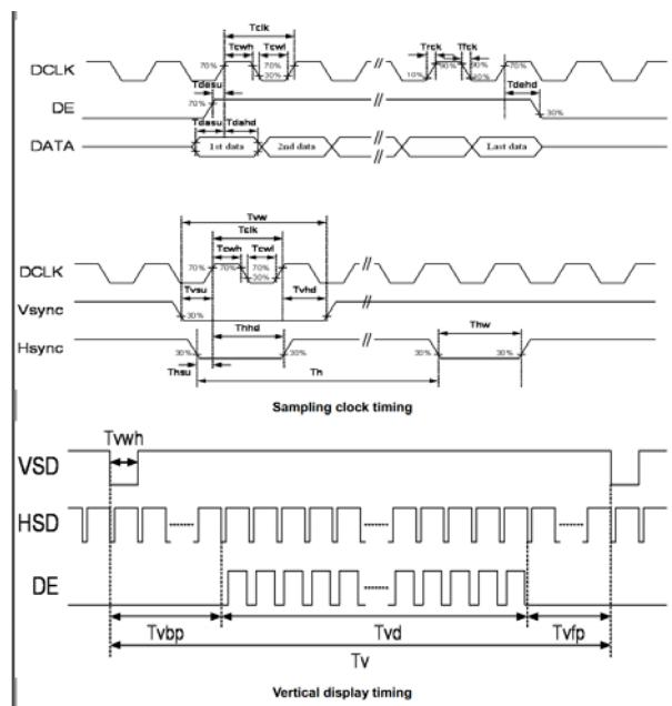
根据上图可知，对于 4.3 寸屏的驱动需要不断给时钟、给数据，类似于 VGA 基于行场扫描的模式，如果用一般的 MCU 通过 GPIO 模拟时序，那么 MCU 基本上做不了其他事了。而 SSD1963/RA8875 恰恰是解决这个问题的方案，它的一侧是对 MCU 的，即 8080 时序，可通过 WR、RD、RS、CS 以及数据线对其进行读写，另一侧则是对通用 TFT 进行不断刷新的接口。我
