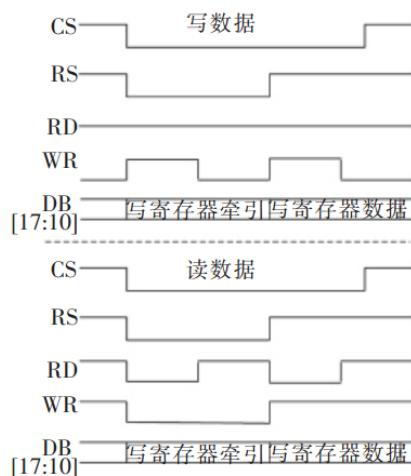
MCU 通过 WR、RD、RS、CS 等控制线以及数据总线即可与之通信，CS 为片选信号，低电平有效，WR、RD 为读写控制信号，RS 为数据、命令选择信号 我们选择了 Freescale 的 KL25Z 来做低成本液晶驱动的参考设计。
