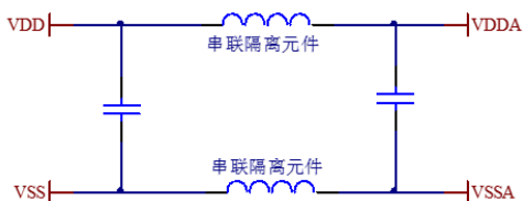
图 2. 数字和模拟电源隔离示意图
