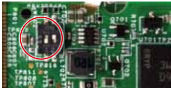
图2：SW602设置为串行下载模式
