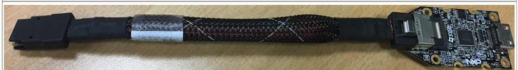
Figure 30. i.MX mini SAS cable with LVDS-to-HDMI adapter
