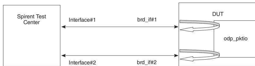
Figure 214. Test setup (odp-pktio)
